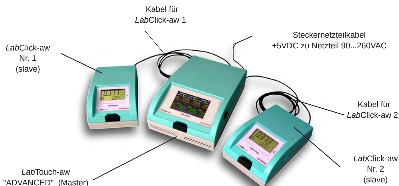
Anschluss-Beispiel eines LabTouch-aw mit 2 LabClick-aw Messkammern (rückseitige Verbindung)
